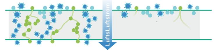
Ein Enzymfilter zerstört die Zellwände der in der Raumluft befindlichen Bakterien, Pilzsporen und Allergene und baut diese biologisch ab.
